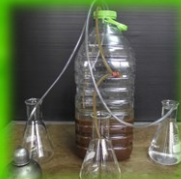
ปิดฝาแล้วปิดระบบอากาศให้ถังหมักอยู่ในสภาวะไร้อากาศ
